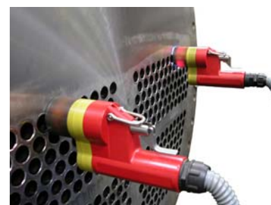
Несколько сварочных головок могут одновременно обслуживаться одним сварщиком
