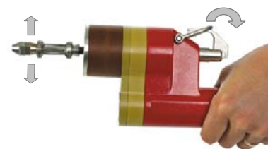
Центрирование / крепление с помощью дорна и рычажного механизма
